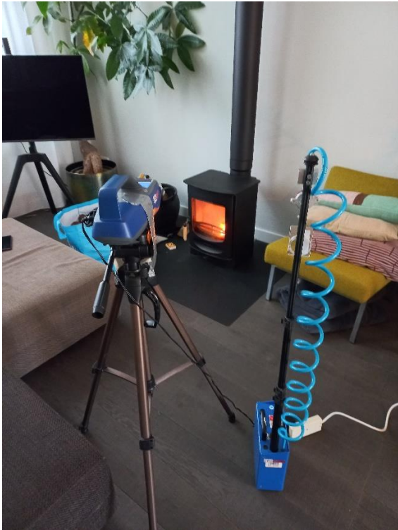
Foto 3: Meetopstelling 1,5 m (stofmonitor links en actieve meting rechts).
