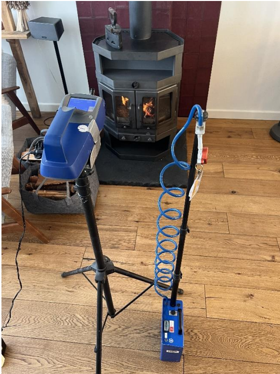
Foto 3: Meetopstelling 1,5 m (deeltjesteller links en actieve meting rechts).
